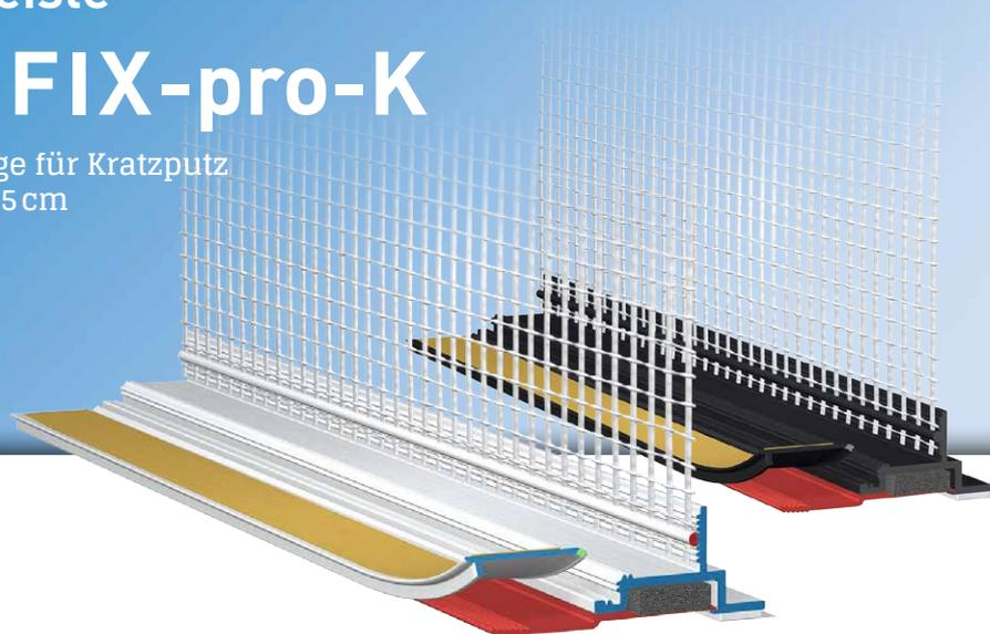
Die **APU-Gewebeleiste PUR-FIX-pro-K** wird in Wärmedämm-Verbundsystemen gemäss den aktuellen APU-Auswahlkriterien eingesetzt. Das Profil wird kurz bevor die Laibungsdämmung angebracht wird fluchtgerecht am Bauteil fixiert und bietet nach Abschluss der Putzarbeiten einen sauberen und sicheren Putzanschluss mit Schattenfuge. Die Profilkontur ermöglicht den Auftrag eines Dick- bzw. Kratzputzes.
