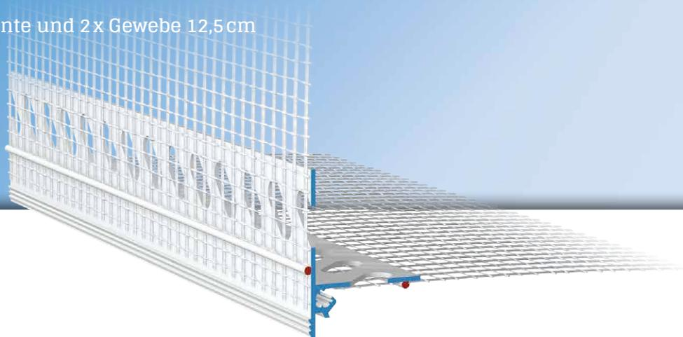
Das **APU-Abschlussprofil DROP-TEX-UNO** wird in Wärmedämm-Verbundsystemen horizontal bei zurückspringenden Gebäudeteilen wie z. B. Fenster- und Türleibungen eingesetzt. Die gerade Profilkontur bietet eine sichere Lösung hinsichtlich der Wasserführung nach unten.
