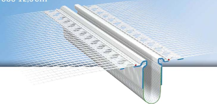
Das **APU-Dehnfugenprofil DUO-TEX** wird in Wärmedämm-Verbundsystemen bei Gebäudefugen eingesetzt. Für die fluchtgerechte Ausbildung einer sauberen Putzkante werden die Profile für die Fläche (W52) und für die Innenecke (W51) hergestellt.
