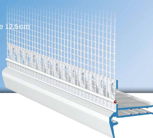
Das **APU-Aufsteckprofil ZERO** wird in Wärmedämm-Verbundsystemen horizontal z. B. bei Putzanschlüssen auf Rollladenkästen oder im Sockelbereich eingesetzt. Die Profilkontur mit sichtbarer Tropfkante bietet eine sichere Lösung hinsichtlich der Wasserführung nach unten.
