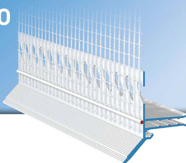
Das **APU-Aufsteckprofil QUATTRO** wird in Wärmedämm-Verbundsystemen horizontal z. B. bei Putzanschlüssen auf Rollladenkästen oder im Sockelbereich eingesetzt. Die schräge Profilkontur für Kratzputz bietet eine sichere Lösung hinsichtlich der Wasserführung nach unten.
