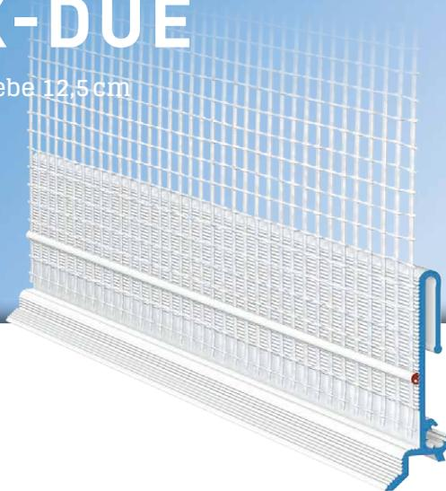
Das **APU-Sockelaufsteckprofil REPO-TEX-DUE** wird in Wärmedämm-Verbundsystemen als Abschluss auf Metall-Sockelschienen in Trog oder T-Form eingesetzt. Damit werden Bewegungen zwischen Putzanbindung und Metallprofil ausgeglichen. Das Sockelaufsteckprofil DUE bildet eine exakte Putzkante.
