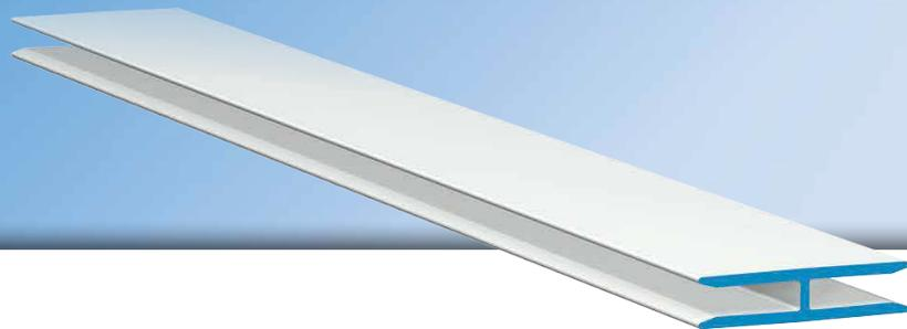
Der **APU-Stossverbinder** Z61 erleichtert die fluchgerechte, versatzfreie Ausrichtung von Sockel und Montageschienen mit einer Materialstärke bis 2,5 mm. Dazu werden die Verbinder mit der Auflagenschere nach Bedarf in Teilstücke abgeschnitten.
