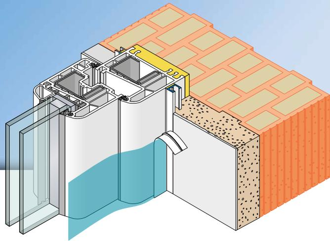
Die **APU-Anputzleiste UNIVERSAL** wird bei Putzsystemen im Innen- und Aussenbereich gemäss den aktuellen APU-Auswahlkriterien eingesetzt. Das Profil wird in der Laibung fluchtgerecht auf das vorhandene Bauteil geklebt und bildet somit einen sicheren und sauberen Putzabschluss.
