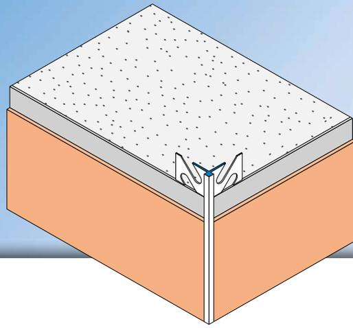
Der **APU-Eckschutzwinkel DUO** wird in Putzsystemen im Innen- und Aussenbereich zur Ausbildung einer fluchtgerechten und exakten Putzkante eingesetzt.
