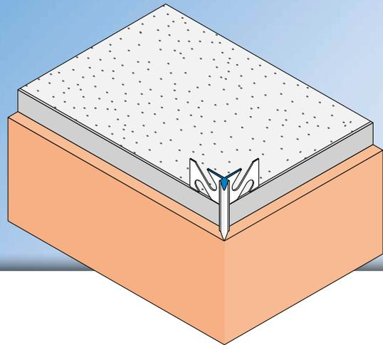
Der **APU-Eckschutzwinkel DUO** wird in Putzsystemen im Innen- und Aussenbereich zur Ausbildung einer fluchtgerechten und exakten Putzkante eingesetzt.
