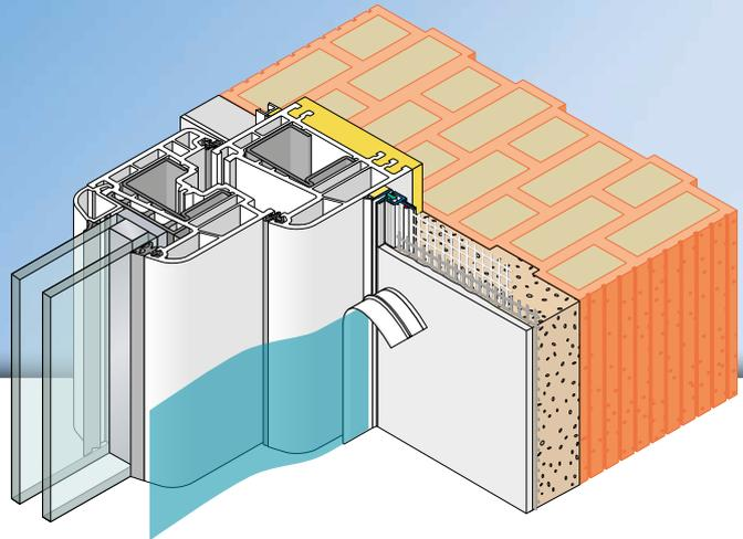
Die **APU-Teleskop-Anputzleiste IDEAL-plus** wird in Putzsystemen im Innen- und Aussenbereich gemäss den aktuellen APU-Auswahlkriterien eingesetzt. Das Profil wird in der Laibung fluchtgerecht auf das vorhandene Bauteil geklebt und bildet nach Abschluss der Putzarbeiten einen sauberen und sicheren Putzanschluss.
