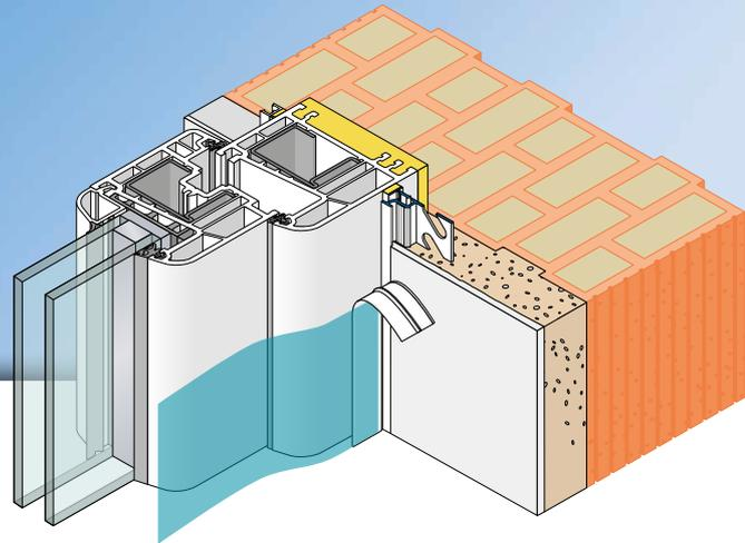
Die **APU-Teleskop-Anputzleiste FLEX** wird in Putzsystemen im Innen- und Aussenbereich gemäss den aktuellen APU-Auswahlkriterien eingesetzt. Das Profil wird in der Laibung fluchtgerecht auf das vorhandene Bauteil geklebt und bildet nach Abschluss der Putzarbeiten einen sauberen und sicheren Putzanschluss.
