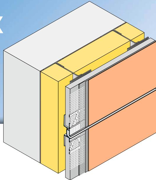
Das **APU-Fugenprofil VHF-DROP-TEX** wird bei vorgehängten, hinterlüfteten Fassaden als Abschluss auf die Kante der Trägerplatte eingesetzt. In Verbindung mit dem Fugenprofil VHF-PRO-TEX (V83) wird somit die Feldbegrenzungsfuge horizontal und vertikal ausgebildet und es entsteht eine saubere Putzkante mit Schattenfuge.
