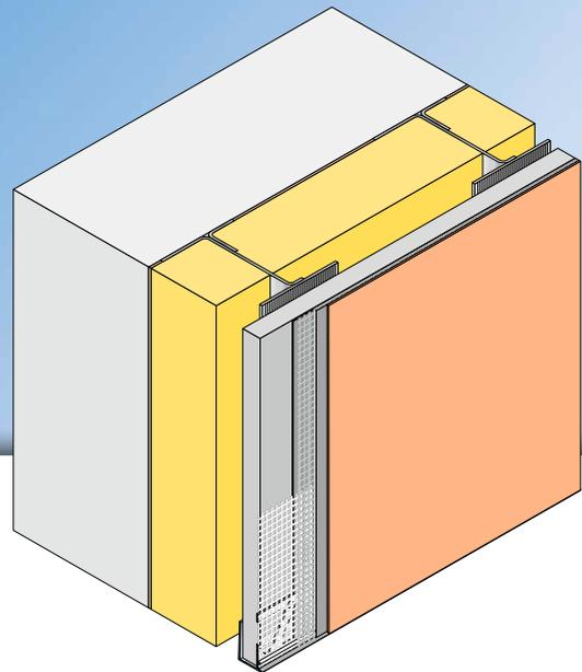
Das **APU-Aufsteckprofil VHF-FIN-TEX** wird bei vorgehängten, hinterlüfteten Fassaden als Abschluss auf die Kante der Trägerplatte eingesetzt.
