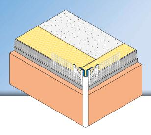
Der **APU-Gewebeeckwinkel DUO-TEX-K** wird in Wärmedämm-Verbundsystemen als fluchtgerechte und stosssichere Kante für Kratz- und Dickputze eingesetzt.
