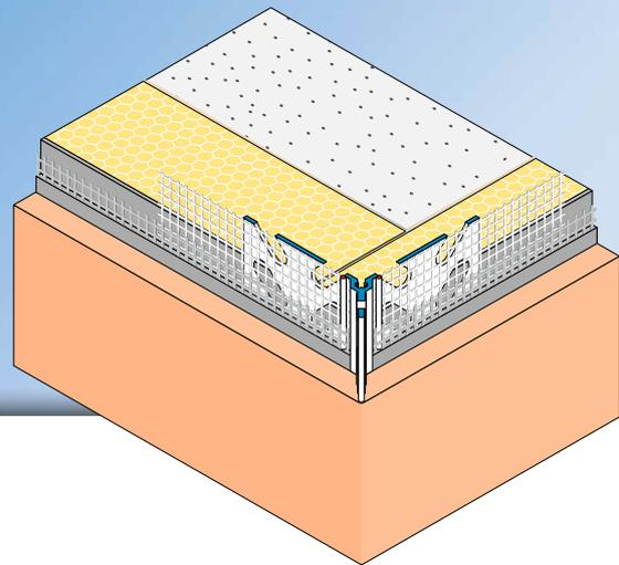
Der **APU-Gewebeeckwinkel STABILO** wird in Wärmedämm-Verbundsystemen als fluchtgerechte und stossichere Kante für Kratz- und Dickputze eingesetzt.
