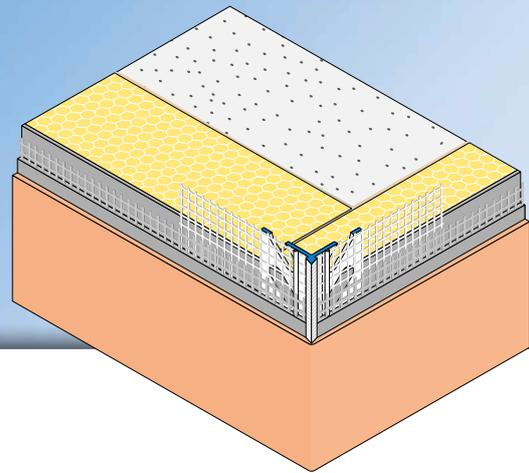
Der **APU-Gewebeeckwinkel TOP-TEX** wird in Wärmedämm-Verbundsystemen als fluchtgerechte und stossichere Kante für dünnlagige Oberputze eingesetzt.
