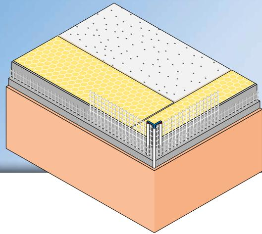
Der **APU-Gewebeeckwinkel MINI** wird in Wärmedämm-Verbundsystemen als fluchtgerechte und stossichere Kante für dünnlagige Oberputze eingesetzt. Bei Bedarf ist der Winkel biegsam und dadurch für Rundungen geeignet.
