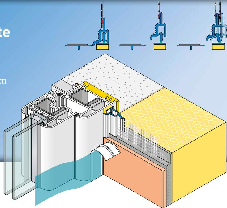
Die **APU-Teleskop-Gewebeleiste FLEX-pro** wird in Wärmedämm-Verbundsystemen gemäss den aktuellen APU-Auswahlkriterien eingesetzt. Das Profil wird vor die Laibungsdämmung fluchtgerecht auf das vorhandene Bauteil geklebt und bietet nach Abschluss der Putzarbeiten einen sauberen und sicheren Putzanschluss mit Schattenfuge.
