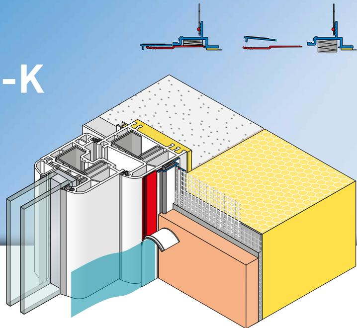
Die **APU-Gewebeleiste PUR-FIX-pro-K** wird in Wärmedämm-Verbundsystemen gemäss den aktuellen APU-Auswahlkriterien eingesetzt. Das Profil wird kurz bevor die Laibungsdämmung angebracht wird fluchtgerecht am Bauteil fixiert und bietet nach Abschluss der Putzarbeiten einen sauberen und sicheren Putzanschluss mit Schattenfuge. Die Profilkontur ermöglicht den Auftrag eines Dick- bzw. Kratzputzes.
