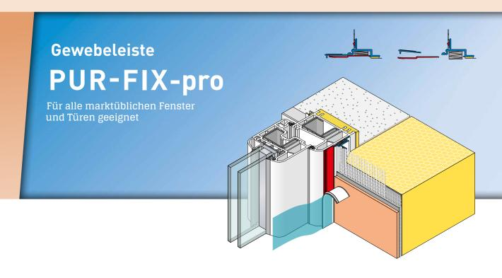
Die APU-Gewebeleiste PUR-FIX-pro wird in Wärmedämm-Verbundsystemen gemäss den aktuellen APU-Auswahlkriterien eingesetzt. Das Profil wird kurz bevor die Laibungsdämmung angebracht wird fluchtgerecht am Bauteil fixiert und bietet nach Abschluss der Putzarbeiten einen sauberen und sicheren Putzanschluss mit Schattenfuge.
