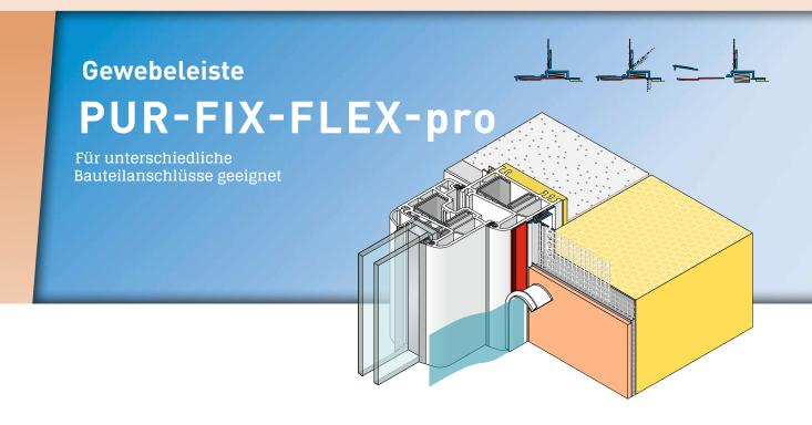
Die APU-Gewebeleiste PUR-FIX-FLEX-pro wird in Wärmedämm-Verbundsystemen gemäss den aktuellen APU-Auswahlkriterien eingesetzt. Durch ihre flexiblen Eigenschaften am Fixierschenkel und am Putzsteg kann sie zusätzlich z.B. bei Laibungen mit Lichtkeil, bei GFB-Sockelelementen und vielen weiteren Einbausituationen eingesetzt werden. Nach Abschluss der Putzarbeiten entsteht ein sauberer und sicherer Putzabschluss mit Schattenfuge.
