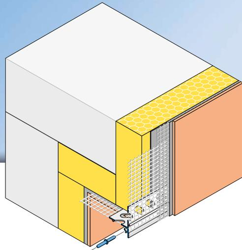
Das **APU-Abschlussprofil DROP-TEX-UNO** wird in Wärmedämm-Verbundsystemen horizontal bei zurückspringenden Gebäudeteilen wie z. B. Fenster- und Türleibungen eingesetzt.
