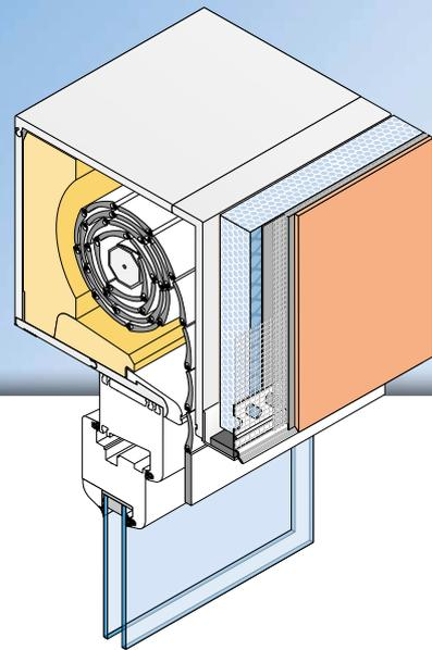
Das **APU-Abschlussprofil DECO-TEX-DUE** wird in Wärmedämm-Verbundsystemen als unterer Putzabschluss oder als horizontale Putztrennung eingesetzt.
