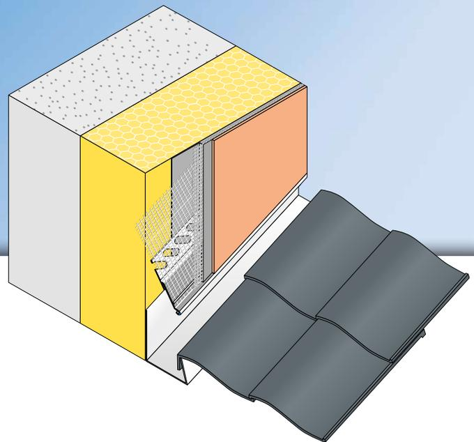
Das **APU-Blechanschlussprofil FIN-TEX MINI** wird in Wärmedämm-Verbundsystemen auf Blechanschlüssen (z. B. Dachrandanschluss) eingesetzt und ergibt durch seine Hohlkammer eine bewegliche Verbindung zwischen Putz und Blech. Das Profil wird für 8 mm Putzstärke eingesetzt und sorgt nach Abschluss der Putzarbeiten für eine gezielte Wasserführung.
