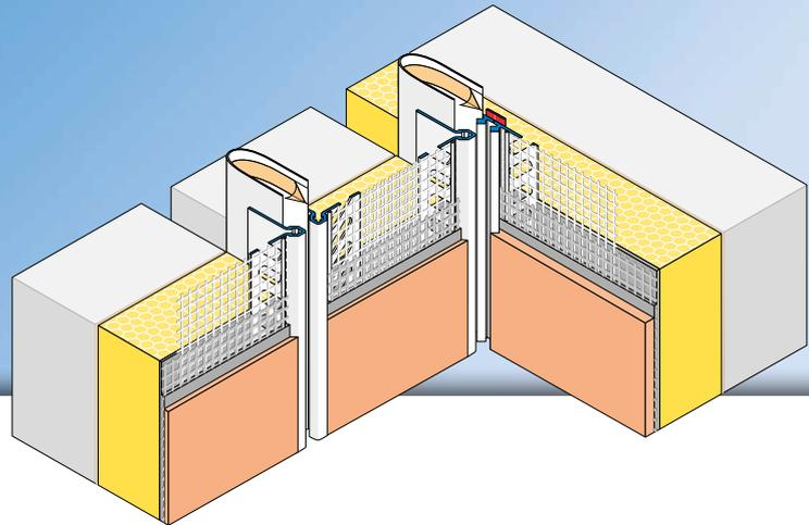
Das **APU-Dehnfugenprofil DUO-TEX** wird in Wärmedämm-Verbundsystemen bei Gebäudefugen eingesetzt. Für die fluchtgerechte Ausbildung einer sauberen Putzkante werden die Profile für die Fläche (W52) und für die Innenecke (W51) hergestellt.
