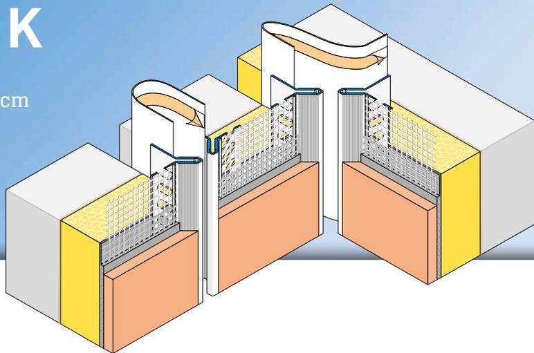
Das **APU-Dehnfugenprofil DUO-TEX-K** wird in Wärmedämm-Verbundsystemen bei Gebäudefugen eingesetzt.
