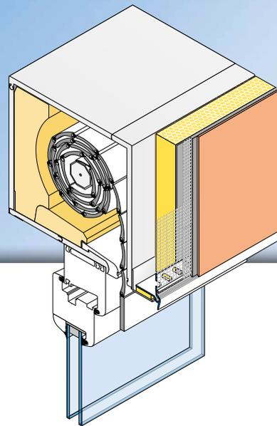
Das **APU-Aufklebeprofil ZERO** wird in Wärmedämm-Verbundsystemen horizontal z. B. bei Putzanschlüssen auf Rollladenkästen eingesetzt. Die Profilkontur mit sichtbarer Tropfkante bietet eine sichere Lösung hinsichtlich der Wasserführung nach unten.
