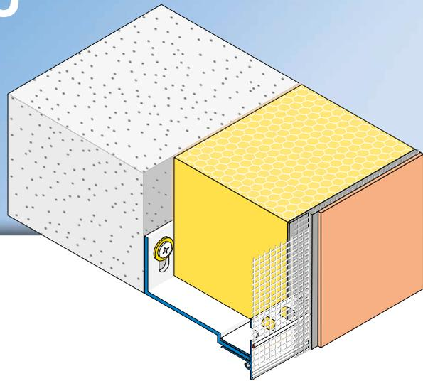
Die **APU-Sockelschiene SOLI-TEX-UNO** wird in Wärmedämm-Verbundsystemen als unterer Abschluss der Wanddämmung eingesetzt. Die Sockelschiene gibt es in verschiedenen Ausladungen. (50, 60, 80, 100, 120, 140 und 160 mm Dämmstoffstärke). Bei grösseren Dämmstoffstärken kann die Sockelschiene mit der Verlängerungsschiene SOLI-TEX (Z63) um jeweils 40 mm auf bis zu 240 mm erweitert werden. Das Aufsteckprofil UNO bildet eine exakte, gerade Putzkante.
