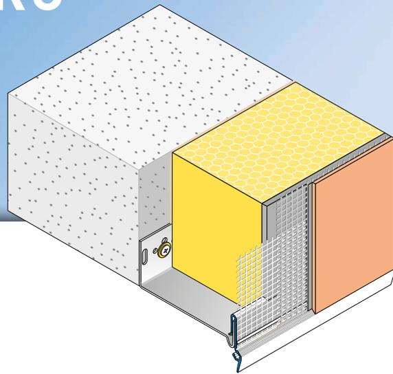
Das **APU-Sockelaufsteckprofil REPO-TEX-ZERO** wird in Wärmedämm-Verbundsystemen als Abschluss auf Metall-Sockelschienen in Trog oder T-Form eingesetzt.
