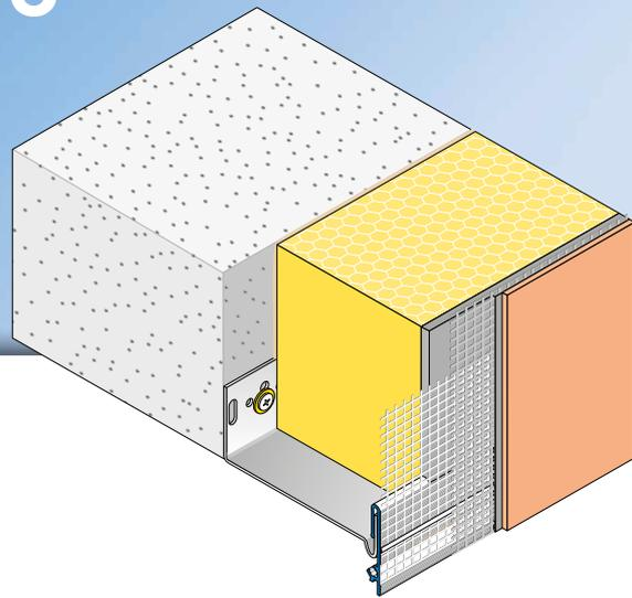
Das **APU-Sockelaufsteckprofil REPO-TEX-UNO** wird in Wärmedämm-Verbundsystemen als Abschluss auf Metall-Sockelschienen in Trog oder T-Form eingesetzt.
