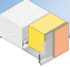
Das **APU-Sockelaufsteckprofil REPO-TEX-DUE** wird in Wärmedämm-Verbundsystemen als Abschluss auf Metall-Sockelschienen in Trog oder T-Form eingesetzt.
