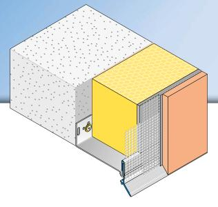
Das APU-Sockelaufsteckprofil REPO-TEX-QUATTRO wird in Wärmedämm-Verbundsystemen als Abschluss auf Metall-Sockelschienen in Trog oder T-Form eingesetzt.
