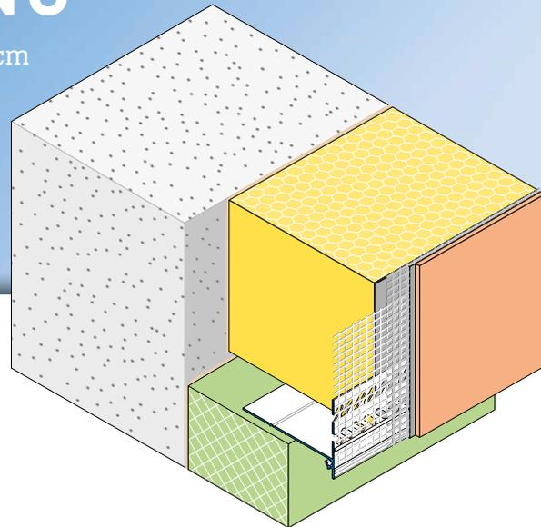
Das **APU-Sockelkantenprofil SOKA-TEX-UNO** wird in Wärmedämm-Verbundsystemen als unterer Abschluss der Wanddämmung eingesetzt. Das Sockelkantenprofil wird je nach Dämmstoffstärke flexibel zwischen Perimeterdämmung und Wanddämmung eingeschoben. Bei unterschiedlichen Dämmstoffstärken kann das Sockelkantenprofil mit der Verlängerung für W66 (Z23) um jeweils 50 mm erweitert werden. Das Sockelkantenprofil bildet eine exakte Putzkante mit Wassernase.
