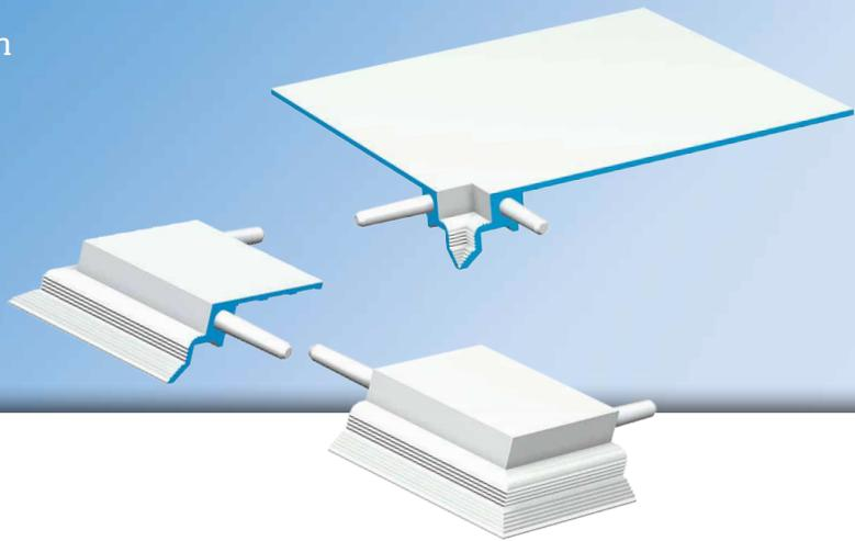
Mit den **APU-Eckverbindern** Z18-i (für Innenecke) und Z18-a (für Aussenecke) lassen sich saubere und exakte Eckausbildungen sehr einfach und schnell herstellen. Die Steckstifte rechts und links am Eckverbinder werden in die jeweiligen Profile gesteckt und somit miteinander verbunden. Alle Profilkanten schliessen dann bündig miteinander ab.
